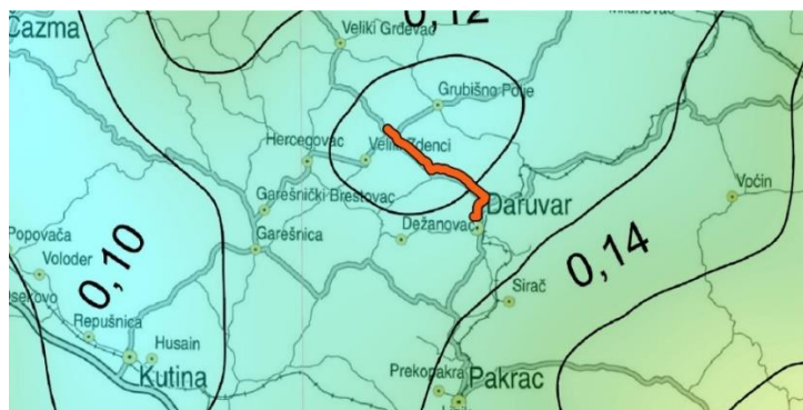
Slika 2.24. Karta poredbenog vršnog ubrzanja tla „A“ okolnog područja za povratno razdoblje od 475 godine (Izvor: Karta potresnih područja Republike Hrvatske Geofizički odsjek PMF, Zagreb)
